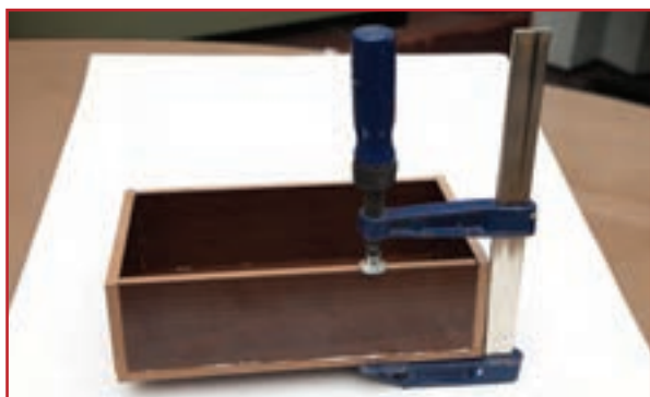
شکل ۷-۱۶- بستن جعبه به وسیله پیچ دستی
