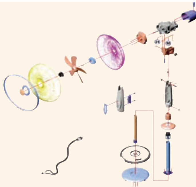
شکل ۱۲-۱- اجزاء سیستم پنکه
